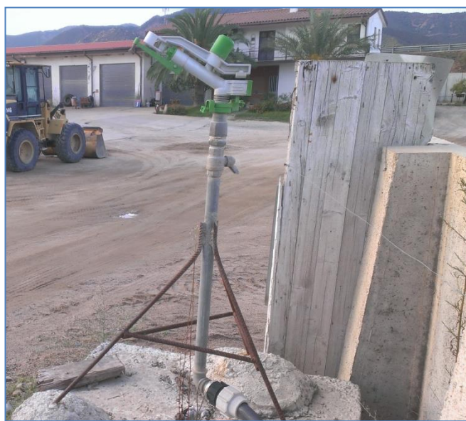
Figura 11 - Nebulizzatori installati lungo il perimetro
